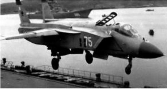
L'ala aveva un'area molto ridotta rispetto alle dimensioni dell'aeroplano, così progettata in quanto un aeroplano a decollo verticale non necessita di molta portanza durante il decollo e l'atterraggio. In tale configurazione, risultava pertanto più idoneo a velocità elevate, permettendo di raggiungere più facilmente capacità supersoniche.
