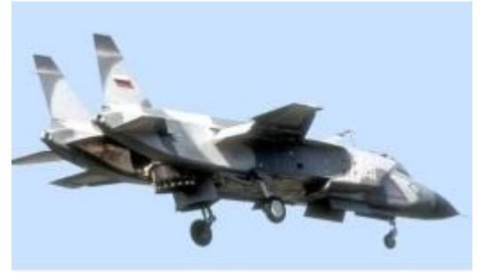
A differenza di quanto progettato inizialmente, si capì poi che il motore principale non poteva fornire abbastanza spinta per sollevare l'aeroplano verticalmente e quindi all'altezza degli ugelli anteriori dietro la cabina di pilotaggio, vennero montati due ulteriori motori il cui compito era solamente quello di alzare l'aeroplano e di tenerlo in volo stazionario.
